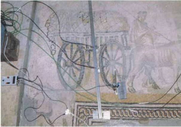
Fig. 6. La technique au chevet de l'oeuvre d'art en péril : on enregistre en 1994 les mouvements et les variations de température qui affectent la mosaïque du Cortège rustique dans son abri.
