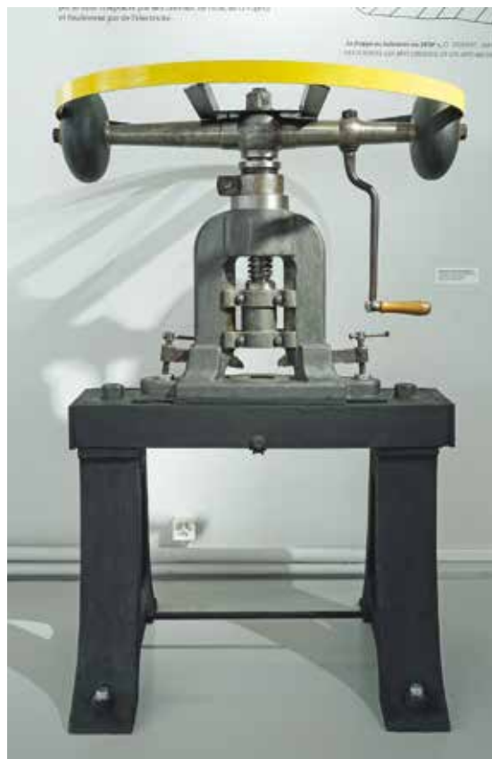
Fig. 11 Balancier de l'entreprise Huguenin, atelier de Genève, réalisé par Gustave Grimm, mécanicien de Genève, fer et acier, Genève, XX e siècle.
