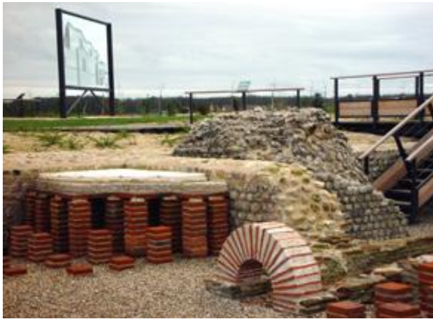
Figure 27 - Restitution du système de chauffage par hypocauste
