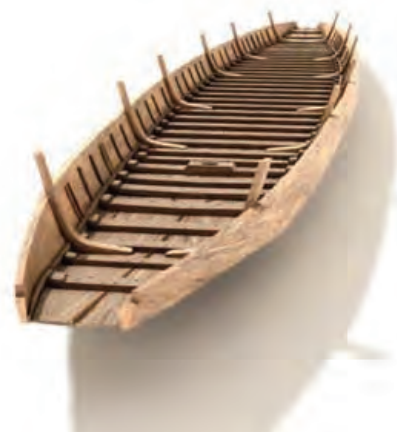
Restitution 3D des structures primaires de la coque du chaland © M. Cazaux / F. Conil / J. Pasquet / D. Schiano / Supinfocom-Arles / MDAA / 2009
