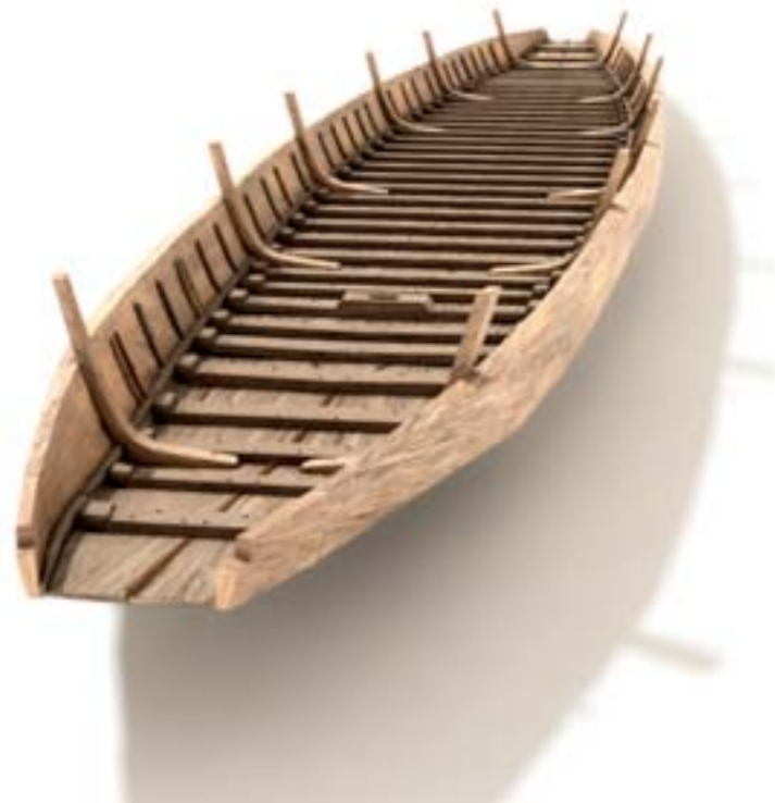
Restitution 3D des structures primaires de la coque du chaland © M. Cazaux / F. Conil / J. Pasquet / D. Schiano / Supinfocom-Arles / MDAA / 2009
