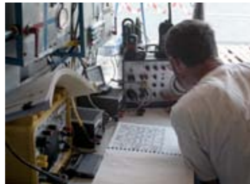
Tant pour leur sécurité que pour échanger les informations sur l'avancée des travaux, les scaphandriers sont en liaison radio permanente avec la surface.
