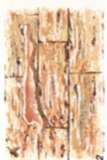
5 Opus mixtum : deux ou trois rangées de briques alternent avec une rangée de pierres.
