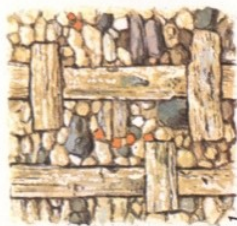
1 Première technique de construction des murs à Pompéi. Moellons maintenus par des blocs de tuf.
